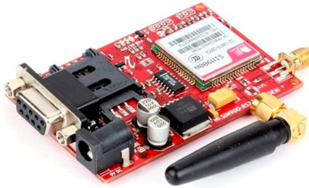
Fig. 5. SIM900A GSM Module [2]
