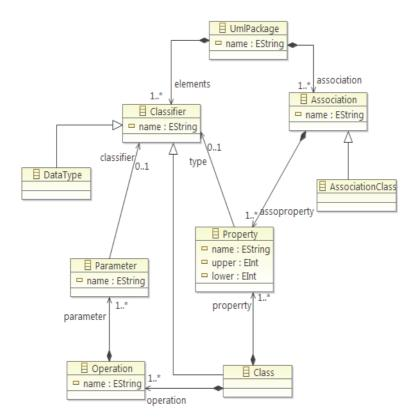
Fig. 3. Simplified UML Meta-Model
