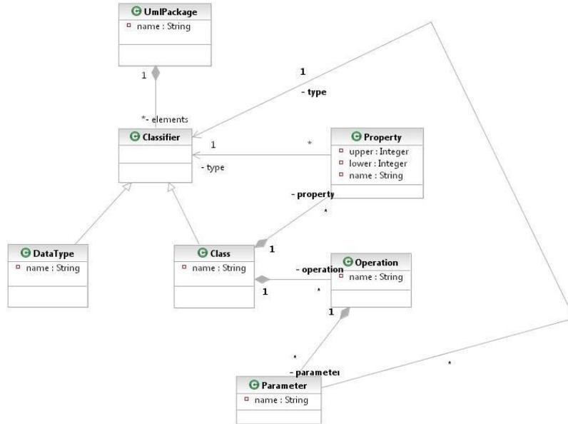
Fig. 7. Simplified UML Meta-Model
